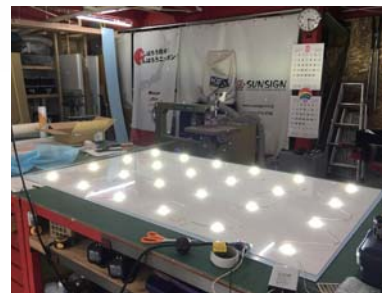
工場内作業(LED組込及び点灯試験)
